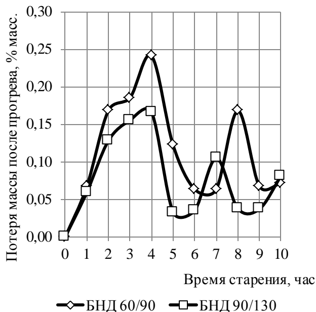
Рисунок 1 – Зависимость потери массы битумов после прогрева от времени старения
