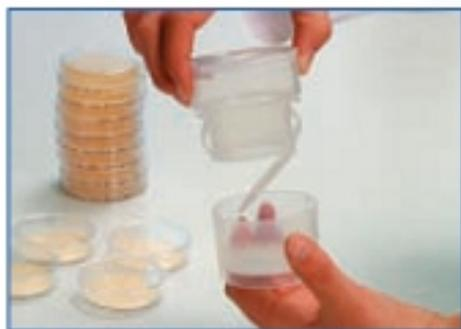
3. Мембрана извлекается из фильтровального аппарата
