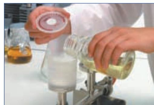
1. Образец фильтруется через готовый фильтровальный аппарат
