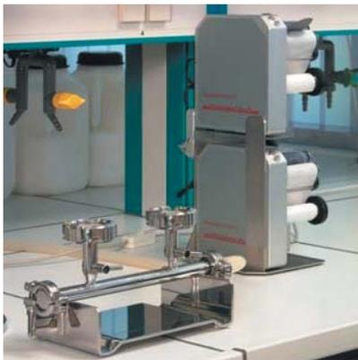
Стойка для одновременной работы с мембранами двух типов
