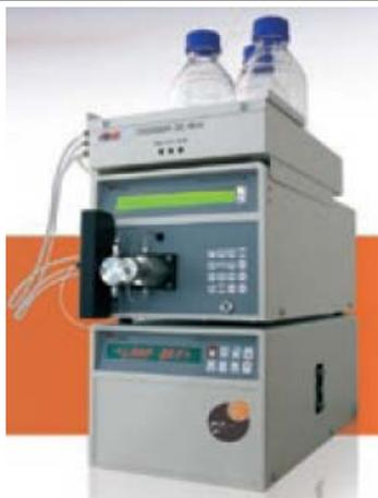
Аналитическая градиентная система HPLC-560. Включает 3-канальный градиентный насос, 4-х канальный дегазатор, инжектор с петлей 20 мкл, термостат колонок, лоток для растворителей с 3-мя бутылками, систему обработки информации с 2-канальным USB-АЦП, установочный набор.
