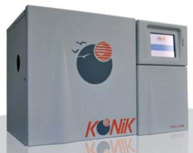
Газовый хроматографа 5000B. Включает модульную раму, панель управления (сенсорную), блок электронного управления пневматикой, многозональный программируемый термостат (индивидуальные отделы колонок, инжекторов, детекторов), капиллярный инжектор, ПИД-детектор, систему обработки информации с 2-канальным USB-АЦП, установочный набор.
