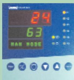
Кат. № 8.15D002 Цифровой программируемый микропроцессор. Память: 10 программ по 10 сегментов. Программируемый таймер: до 99 ч 59 мин. 59 сек. Повторение программы: до 99 раз. Программы можно соединять (до 4). Интерфейс RS232 для передачи данных на принтер и компьютер.
