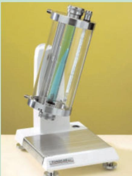
Вискозиметр «ВИСКОБАЛ» используется в основном для анализа веществ низкой вязкости, например, использующихся в следующих отраслях:
