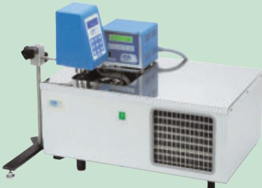
Температура значительно влияет на вязкость, при низкой температуре вязкость увеличивается. Следовательно, для точного измерения вязкости необходимо контролировать температуру. Наиболее эффективно использование термостатируемых бань, так как циркулирующая жидкость позволяет быстро создать стабильную температуру.
